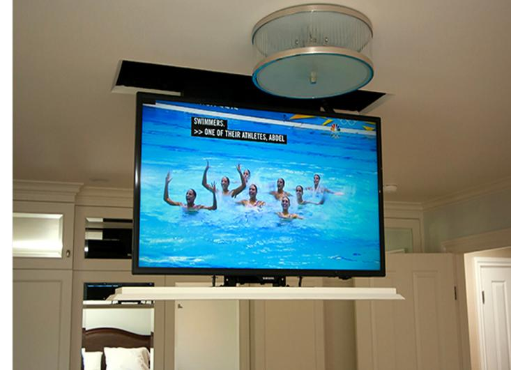
AZIONANDO IL TELECOMANDO, IL MECCANISMO CONSENTE L'APERTURA ED IL RIENTRO AUTOMATICO DEL FLAP E LA DISCESA DEL TELEVISORE.
